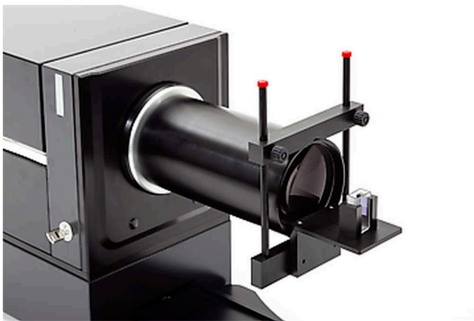
Medição úmida empregando uma célula de lote
