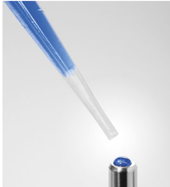
Abb. 1 Messung eines Tropfens auf der Spitze der Sonde
