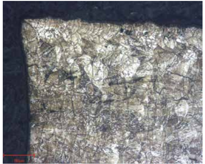
Abb. 7: Probe nach Ätzung mit "V2A Beize" (45 Sek.). Probenrand. Das Gefüge ist deutlich erkennbar.
