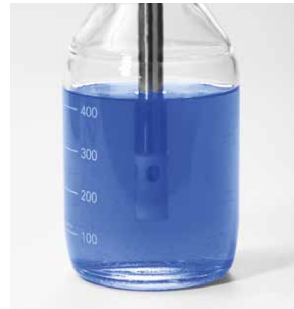
Abb.4 Messung mit dem FLOWGUARD in einem Behälter
