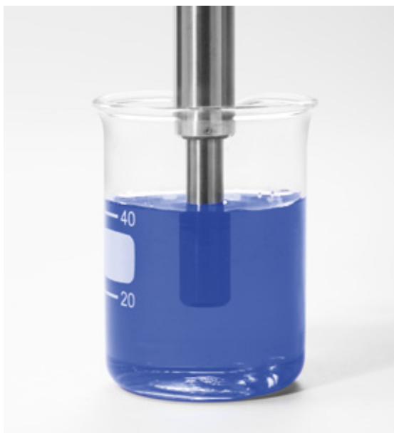
Использование лабораторных стаканов и любых других емкостей в качестве измерительной ячейки
