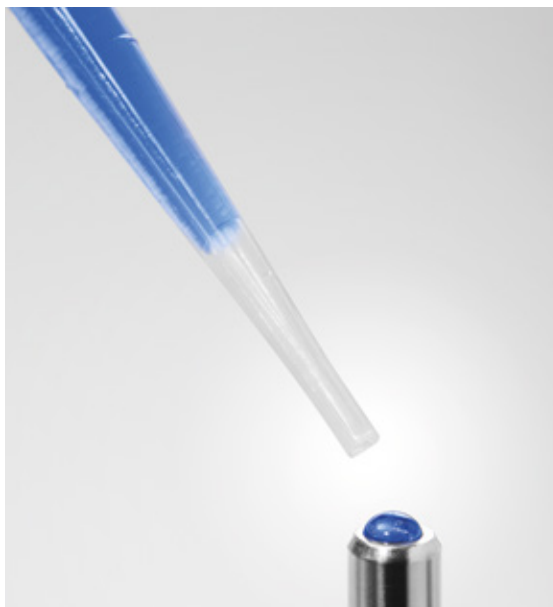
Анализ образца в виде капли на наконечнике зонда
